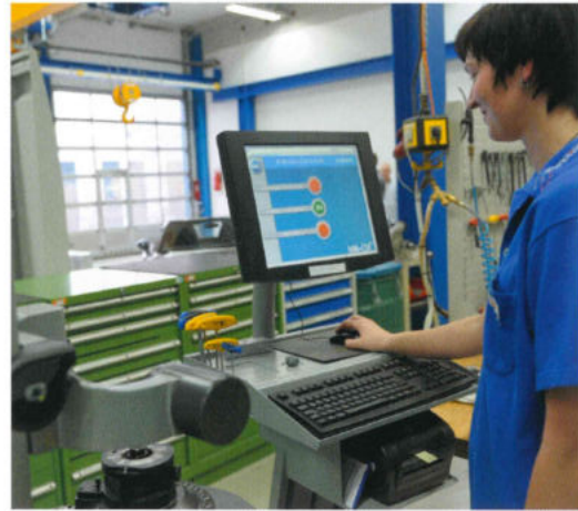
Das ‚MR-CM‘-System von CAM Reinhausen verknüpft die Informationen der unterschiedlichen am Fertigungsprozess beteiligten Systeme miteinander und erzeugt ‚just-in-time‘ die je erforderlichen Datensätze.
