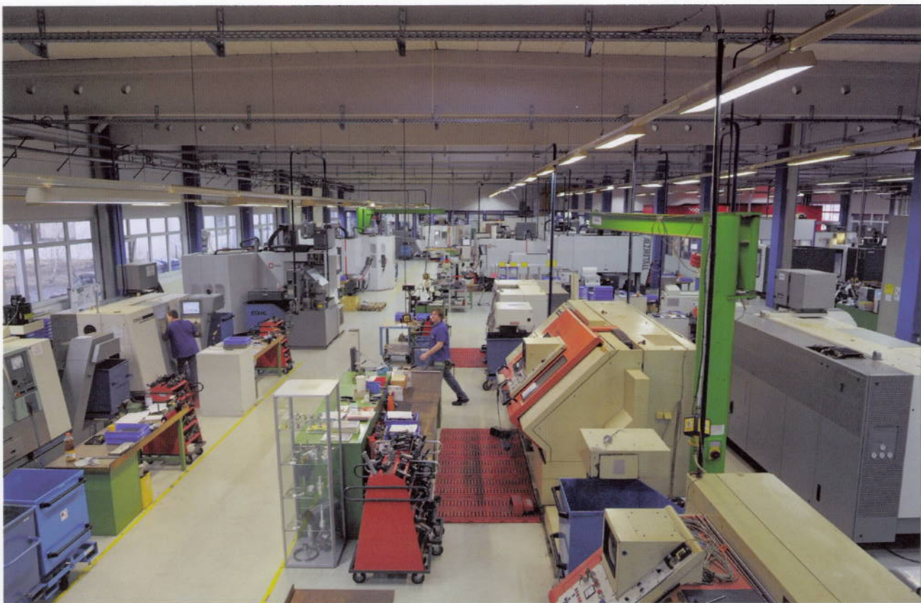
Bild 1: 40 NC-Maschinen sowie NC-Programmierung, NC-Verwaltung, Einstellgerät, Werkzeugdatenbank, Meister, Qualitätssicherung und das PPS-System sind durch MR-CM informationstechnisch vernetzt. Es ermöglicht die bi-direktionale Online-Kommunikation der verschiedenen „Akteure“ in Echtzeit
