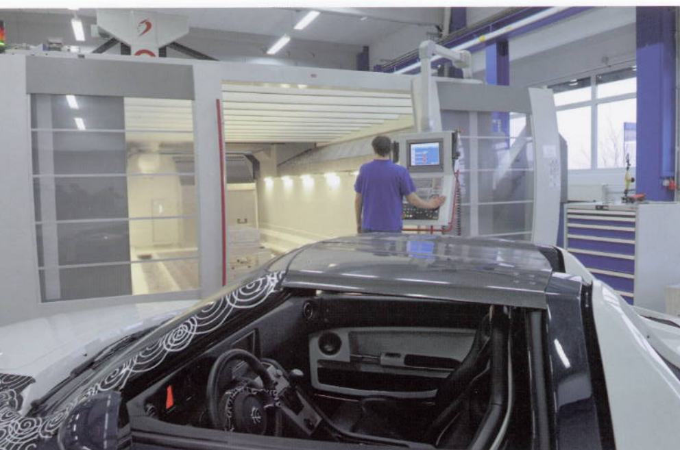
Bild 4: Zur Fertigungssteuerung setzt die Stangl Präzisionstechnik, die unter anderem auch Bauteile und Werkzeuge für den Roding Roadster herstellt, auf MR-CM. Das Manufacturing-Execution-System (MES) stellt den Mitarbeitern der NC-Fertigung aufgabenbezogene, einfach durch Touchscreen zu bedienende Oberflächen auf den jeweiligen Bildschirmen der Maschinen zur Verfügung (Werkbilder: Reinhausen CAM, Regensburg)
