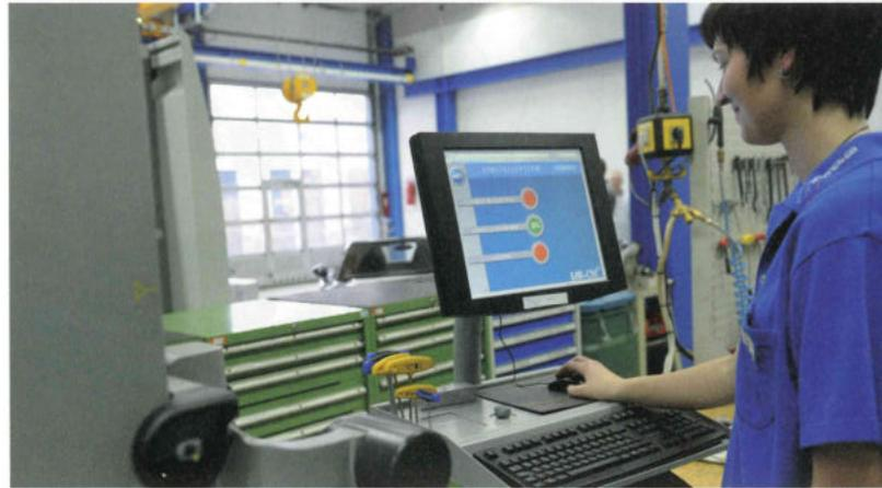
Um einen optimalen Werkzeugumlauf zu gewährleisten, führt MR-CM am Einstellgerät online eine aktuelle Brutto-/Netto-Berechnung mit der ausgewählten NC-Maschine durch. Diese ist Basis für das anschließend automatisch erzeugte Lagerentnahme- und Einstellprogramm.
