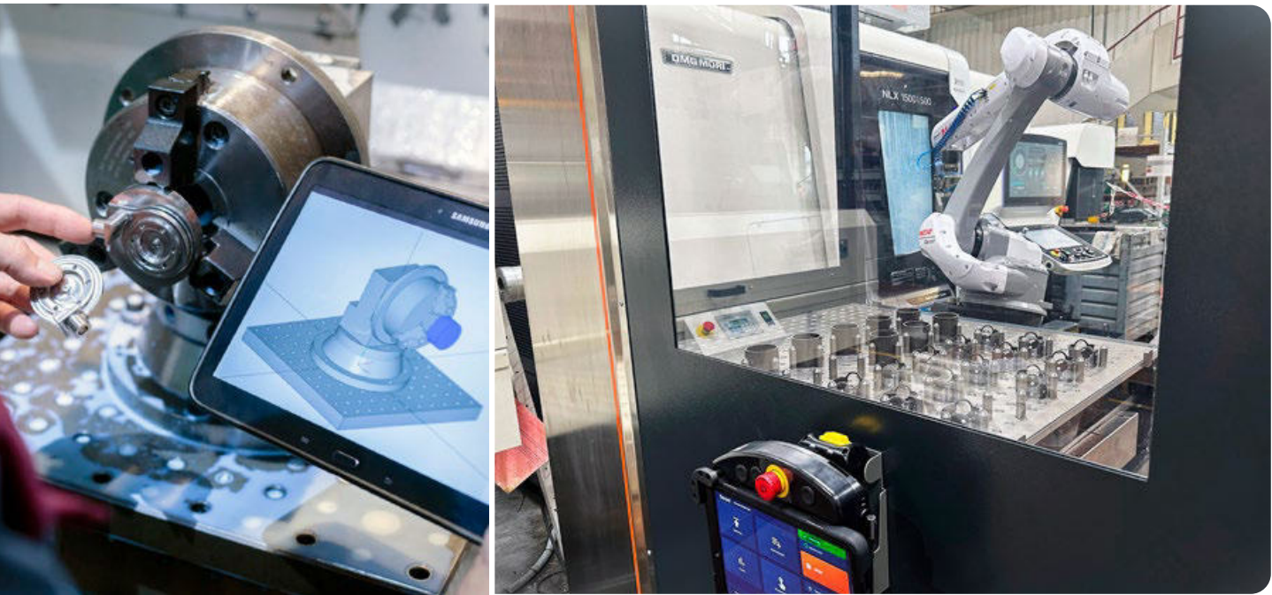
Auf dem Weg zur Digitalen Fabrik setzt Merten bereits heute auf durchgängige CAM-Programmierung, digitale Apps zur Fertigungsbegleitung sowie automatisierte Werkstückhandhabung mittels Roboteranbindung an die Werkzeugmaschinen. Die nächsten Entwicklungsschritte sind nun klar definiert.
