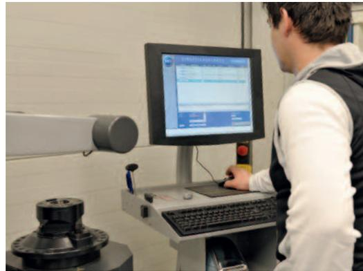
*Für einen optimalen Werkzeugumlauf wird am Einstellgerät online eine aktuelle Brutto/Netto-Berechnung mit der ausgewählten NC-Werkzeugmaschine durchgeführt – auf ihr basieren das anschließend automatisch generierte Lager-Entnahme- sowie das vollständige Einstellprogramm der Werkzeuge.*
