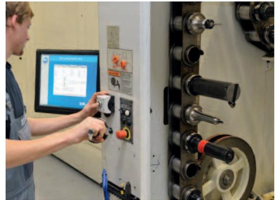
*Zum einfachen, schnellen und sicheren Beladen wurden die Mazak-WZMs zusätzlich mit einem Bildschirm-Terminal ausgestattet, das dem Maschinenbediener das Werkzeug mit Nummer und den Magazinplatz anzeigt; zeitgleich fährt das Kettenmagazin (gesteuert durch ein vom ‚MR-CM‘ erzeugtes Programm) auf die Be/Entlade-Position.*
