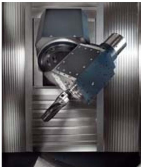
Die C-Achse im Werkzeug ermöglicht eine 5-Achs-Bearbeitung (simultan) mit frei wählbarem Bearbeitungswinkel
