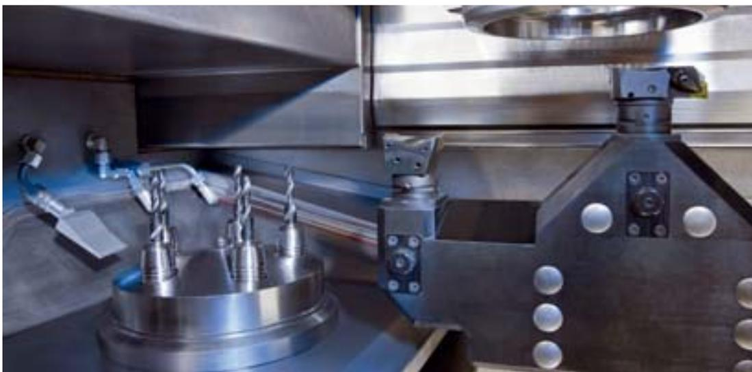
Weisser integriert in seinen multifunktionalen Präzisionsmaschinen je nach Aufgabenprofil und Kundenwunsch verschiedene Fertigungsverfahren, z. B. patentiertes Rotationsdrehen, Hartdrehen, Unrunddrehen, Bohren und Fräsen, Schleifen oder Bandfinishen
