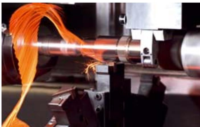
*Das patentierte Rotationsdrehverfahren, ein tragendes Element des Greenplus-Konzeptes, generiert fein bearbeitete Oberflächen und ersetzt aufwändige Schleifoperationen*
