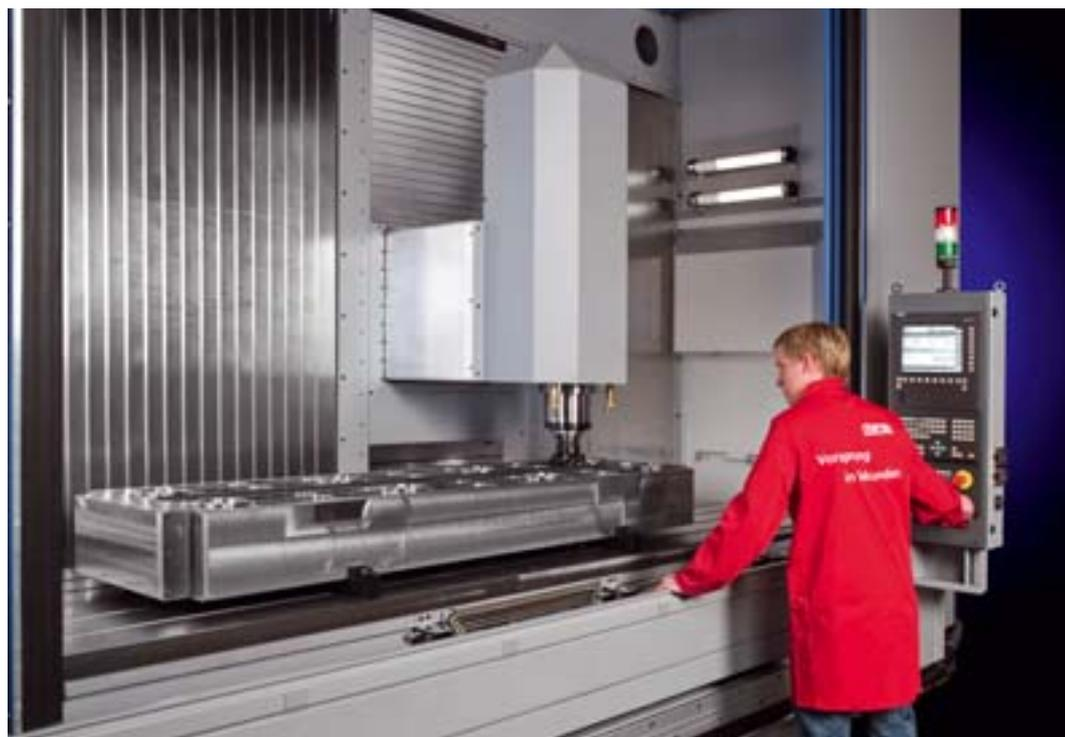
Die X-Achse der Big Mill ist zwischen 1250 und 6000 mm Verfahrweg ausführbar. Dies bietet viel Raum für extra große Werkstücke
