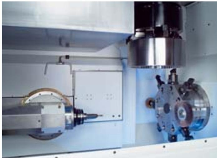
*Auch für Multitechanologianwendungen geeignet: Die VLC – ein Dreh-/Fräszentrum mit 5-Achsbearbeitung, leistungsstarker Frässpindel und bis zu 48 Werkzeugplätzen*
