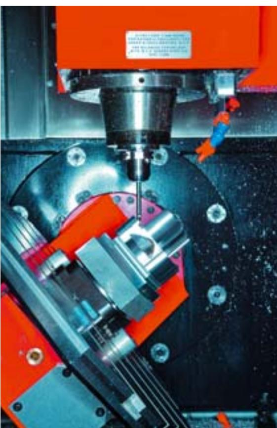
*Maxxmill 500: Arbeitsraum mit Schwenk- und Rundachse*
