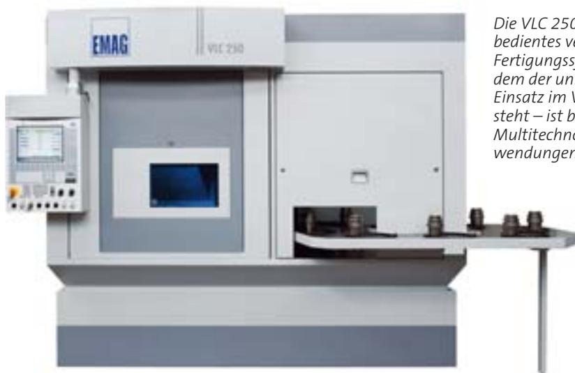
*Die VLC 250 – ein querbedientes vertikales Fertigungssystem, bei dem der universelle Einsatz im Vordergrund steht – ist bestens für Multitechnologie-Anwendungen geeignet*
