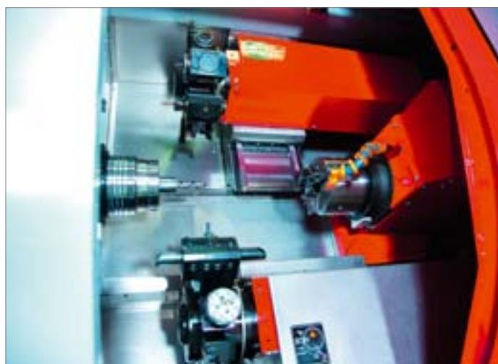
*Arbeitsraum der Hyperturn 45 mit zwei Revolvern und Y-Achse*
