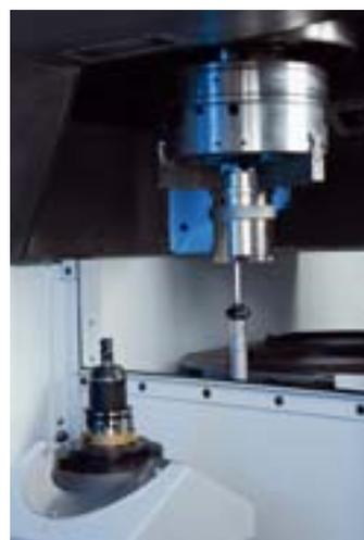
*Universeller Einsatz der VLC 250 durch Technologieintegration sowohl bei der Weich- als auch bei der Hartbearbeitung. Drehen, Bohren, Schleifen, Fräsen – alles in einer Maschine (links) Die Werkstückvermessung erfolgt durch Messtaster oder Messdorn genau, schnell und ohne Umwege in der Arbeitsspannung (rechts)*
